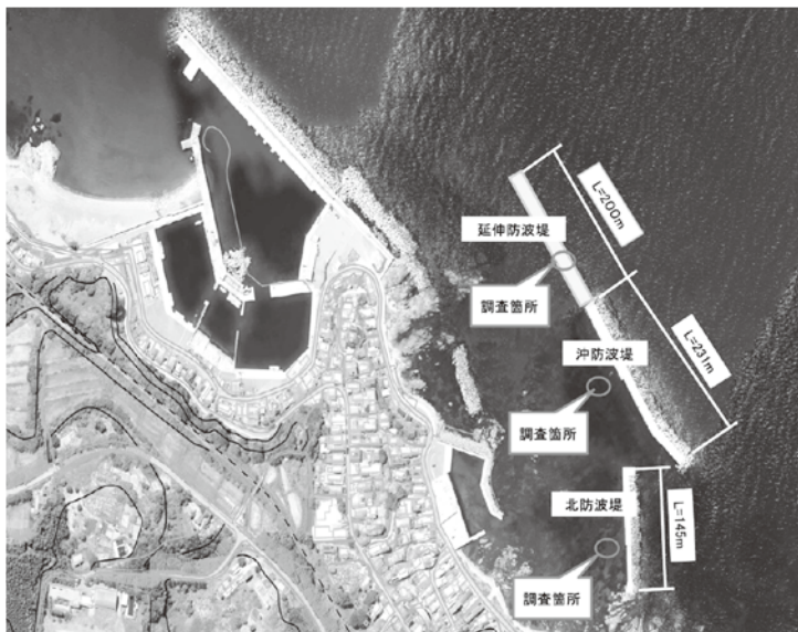
岩館漁港防波堤延伸のための調査箇所
